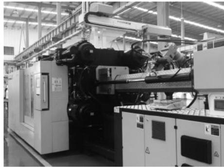
图 5 注射机整机图
